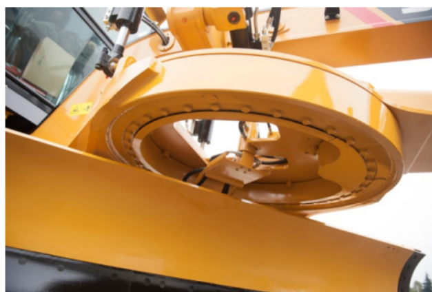
Рабочее устройство опорно-поворотного подшипника
